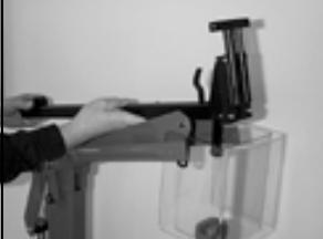
**S** Demontera de två skruvarna som håller länk till häfthuvudet. Håll emot med en skiftnyckel på oket så att drivaren ej böjs.
