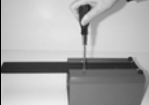
**S** Demontera de fyra skruvorna till plåtskyddet.
