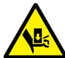
Sešivačky obsahují mechanismus pro sevření spony. Tento mechanismus může rozdrtit části těla např. prsty. Páskovačky mohou sevřít a rozdrtit části těla mezi pásku a produkt při utahování.
