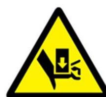
Sešívačky obsahují mechanismus pro sevření spony. Tento mechanismus může rozdrtit části těla např. prsty. Páskovačky mohou sevřít a rozdrtit části těla mezi pásku a produkt při utahování.
